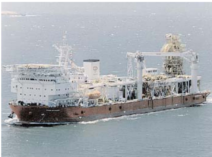
Figura 3.4.1-b. Foto da embarcação Sunrise 2000 a ser utilizada na instalação das linhas de fluxo em Albacora Leste.
