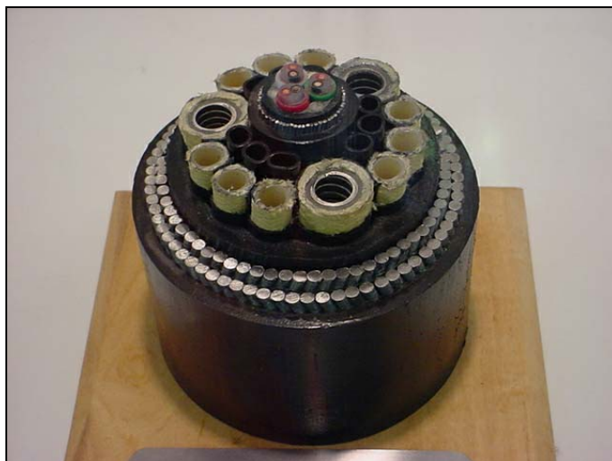
Figura 3.3.1-d. Vista da seção transversal de um Umbilical Eletro-Hidráulico Fonte: PETROBRAS
