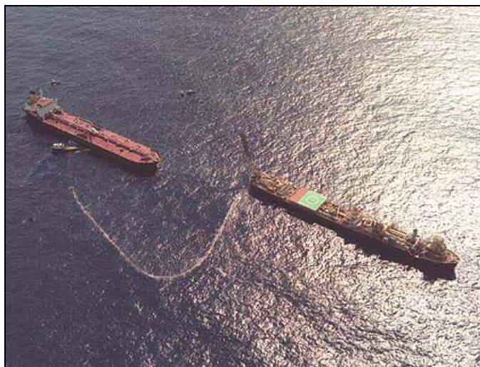
Figura 3.6.1-a. Exemplo de operação de transferência de óleo in tandem . Fonte: PETROBRAS
