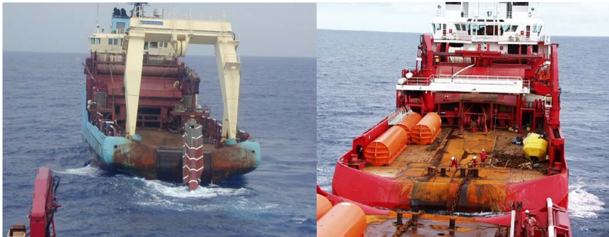
Figura 3.4.3-b. Foto das embarcações de suporte Maersk Boulder (esq) e Far Sailor (dir) típicas, que poderão ser utilizadas na instalação da ancoragem do FPSO P-50 em Albacora Leste.
