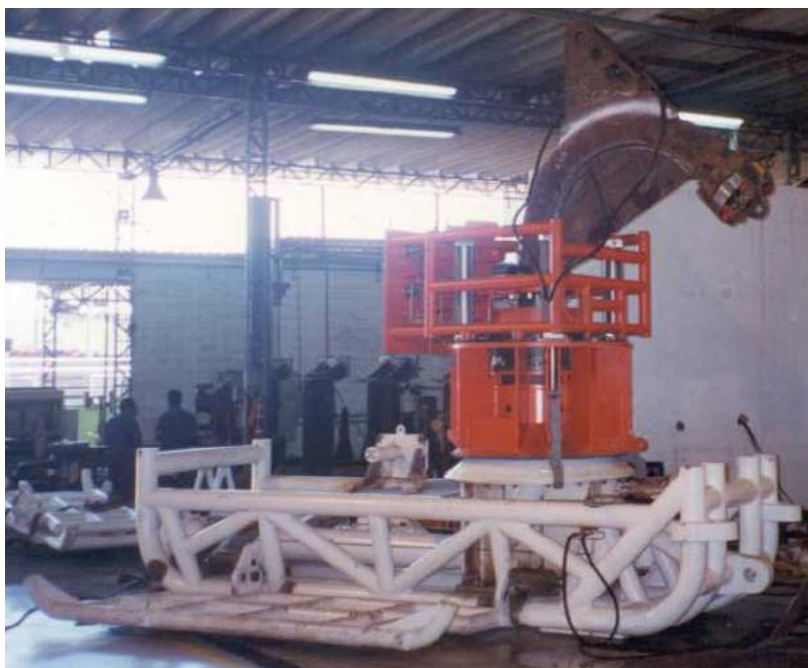
Figura 3.3.2-b Foto de um Pipeline End Termination – PLET.
